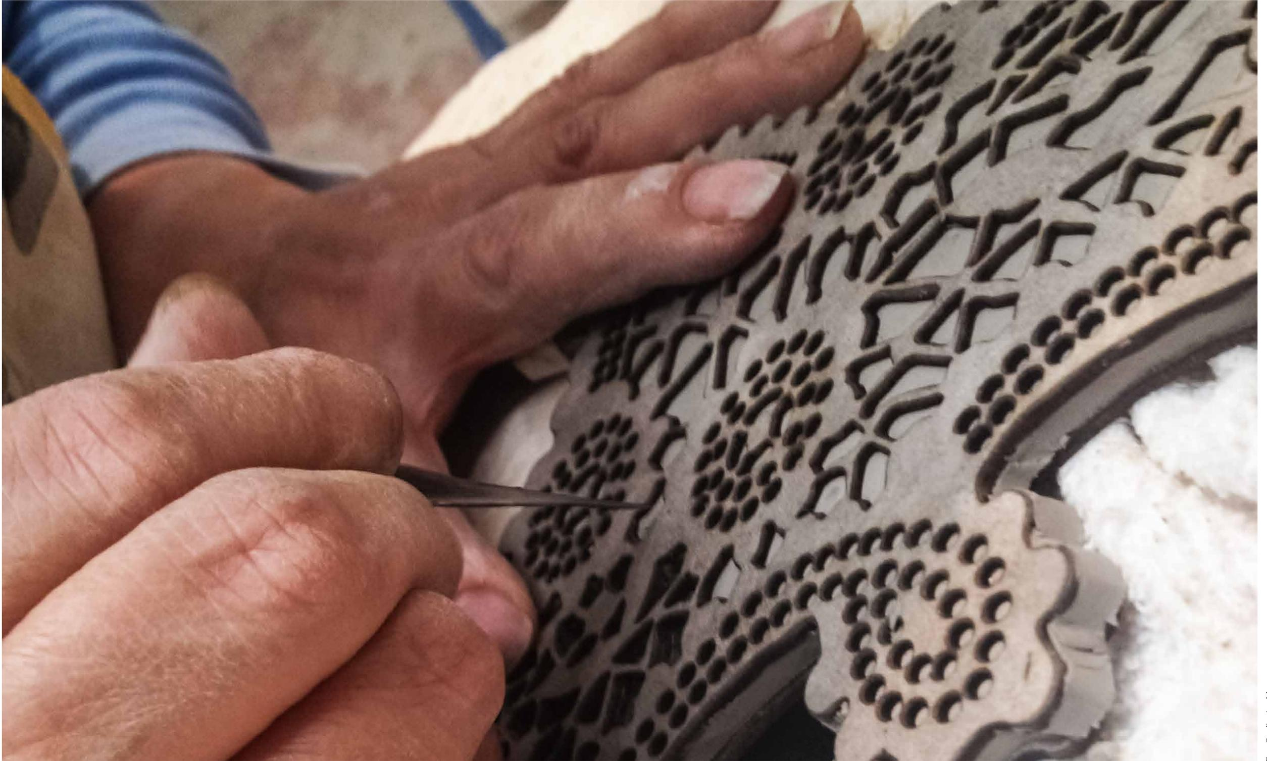
❖❖ Proceso de fabricación de encaje calado en cerámica.
